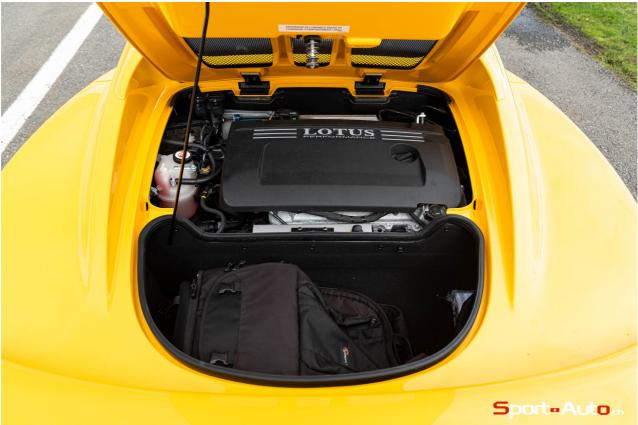
Das Herzstück der Elise, in der hinteren Mittelposition, ist ein original Toyota-Vierzylinder-Kompressormotor. Mit 1,8 Liter Hubraum leistet er 240 PS; genau das Doppelte der in meiner Garage geparkten Elise.
